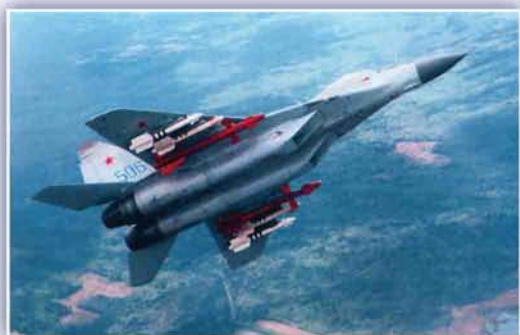
Первый в мире сварной сверхзвуковой истребитель МиГ-29М, изготовленный из сверхлегкого Al-Li сплава 1420
