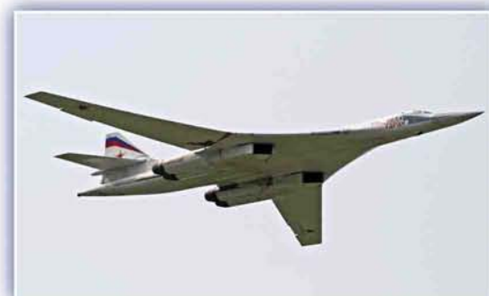
Самолет Ту-160. Верх крыла – из сплава В95, низ крыла и обшивка фюзеляжа – из сплавов Д16 и 1163. Силовой каркас – из сплавов В93 и 1933
