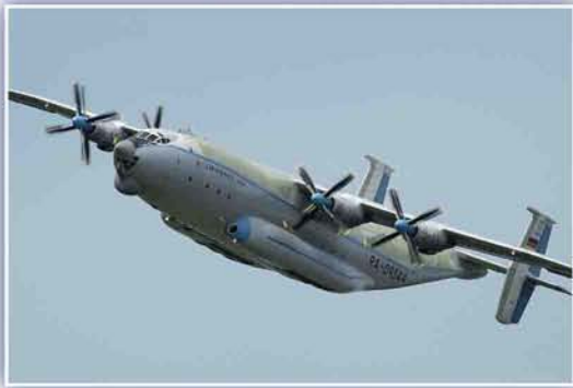
Первый в мире широкофюзеляжный самолет Ан-22 – «Антей» – для перевозки тяжелой крупногабаритной техники. Конструкции изготовлены из высокопрочного ковочного сплава В93
