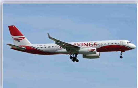
Новый магистральный самолет для линий средней протяженности Ту-204. Верх крыла – из сплава В95, низ крыла и обшивка фюзеляжа – из сплава 1163. Силовой каркас – из сплава 1933. В ряде деталей использован сверхлегкий Al-Li сплав 1420
