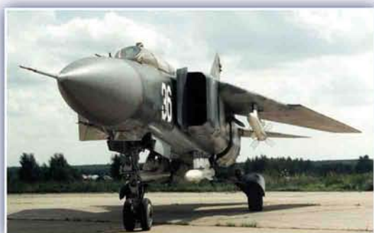
Многоцелевой истребитель МиГ-23 из высокопрочного алюминиевого сплава В95. Выпущено 16 тыс. самолетов
