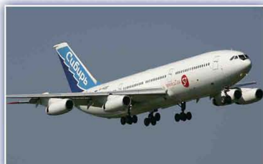
Широкофюзеляжный пассажирский самолет Ил-86. Верх крыла изготовлен из сплава В95, низ крыла и обшивка фюзеляжа – из сплавов Д16 и 1163. Силовой каркас – из сплава В93
