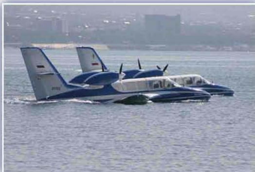
Гидросамолет Бе-103 фирмы Г.М. Бериева из высокотехнологичного Al-Li сплава 1441
