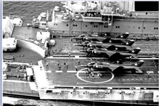
Палубный самолет вертикального взлета Як-38. Изготовлен с применением сверхлегкого Al-Li сплава 1420
