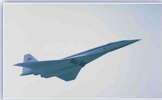
Сверхзвуковой пассажирский самолет Ту-144, созданный из жаропрочного алюминиевого сплава АК4-1
