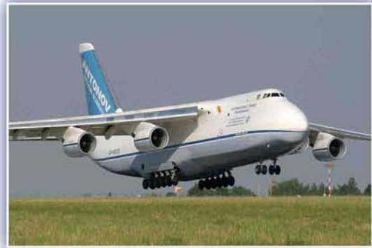
Тяжелый широкофюзеляжный транспортный самолет Ан-124 – «Руслан». Конструкции изготовлены из высокопрочного ковочного сплава В93 и сплава 1933
