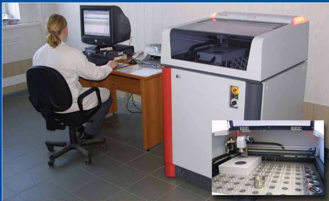
Оптический спектрометр ARL-4460 для определения химического состава сплавов
