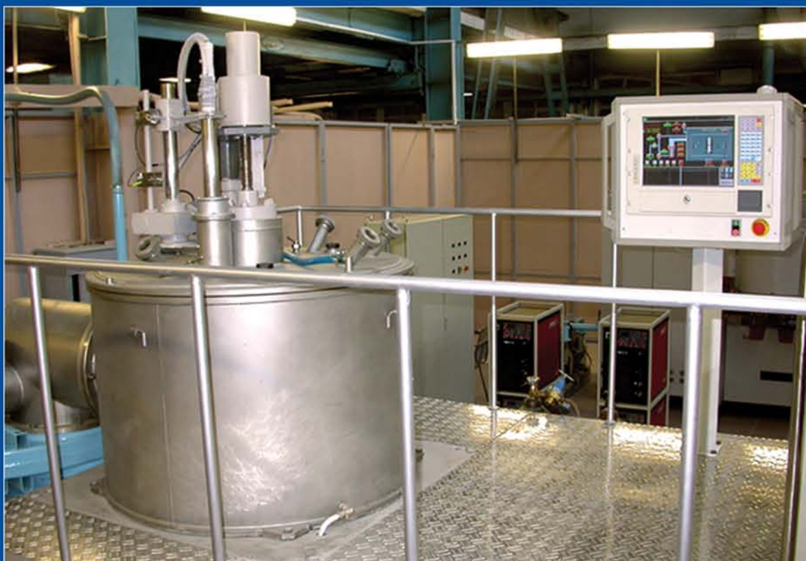
Установка МАП-2 для нанесения ионно-плазменных защитных покрытий на лопатки газовых турбин
