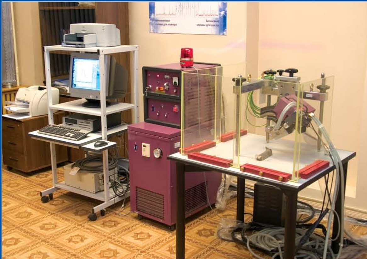
Рентгеновская установка PSF-3M фирмы Rigaku для определения остаточных напряжений
