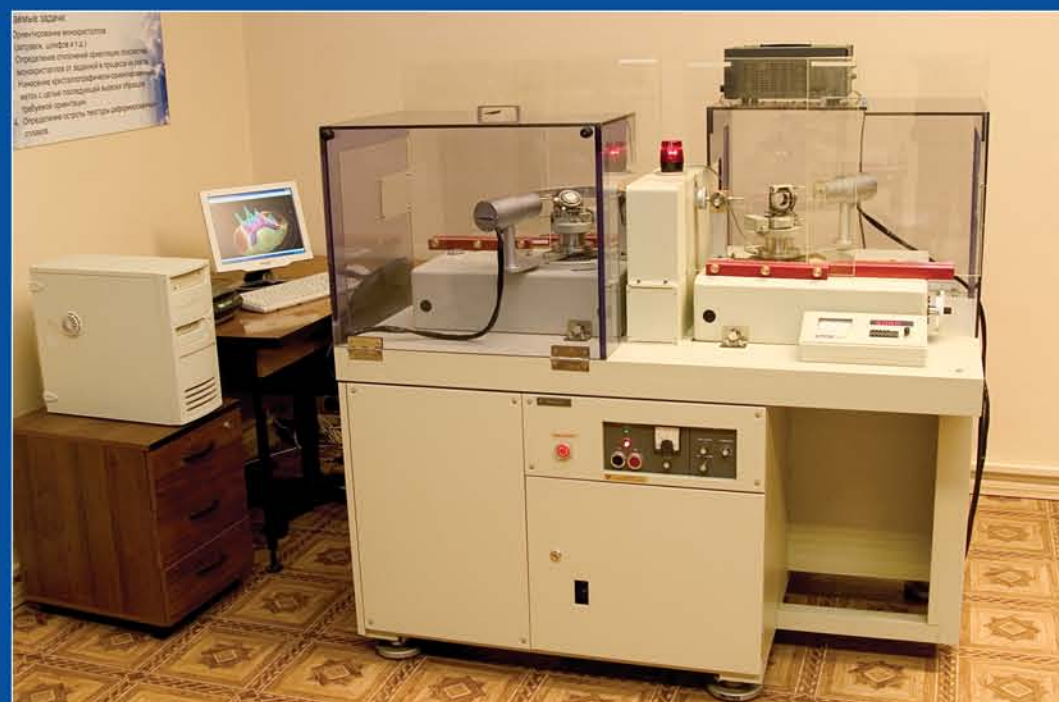
Пьезогониометр 2991G2 фирмы Rigaku для определения кристаллографической ориентации монокристаллов и текстурных характеристик поликристаллов
