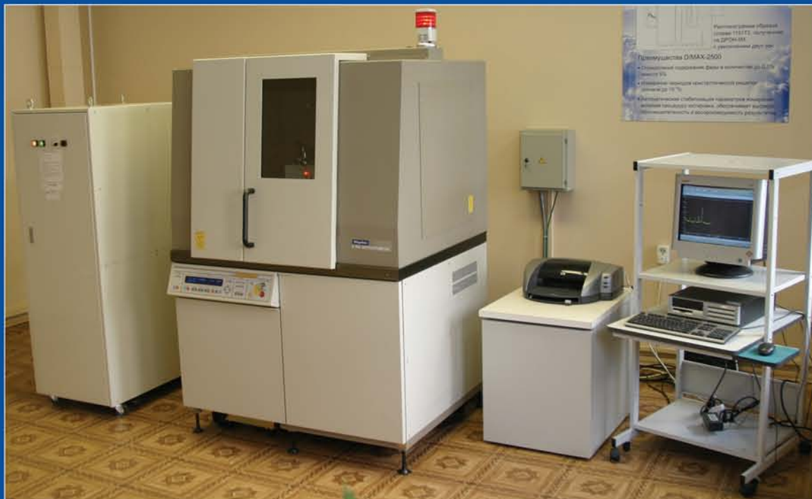
Сверхмощный дифрактомер D/MAX-2500 фирмы Rigaku для рентгеноструктурных исследований
