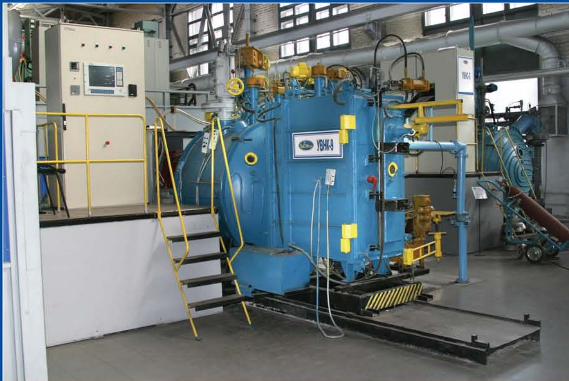
Плавильно-заливочная установка УВНК-9 для отливки монокристаллических лопаток
