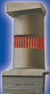
Лопатка с радиально-канальным охлаждением
