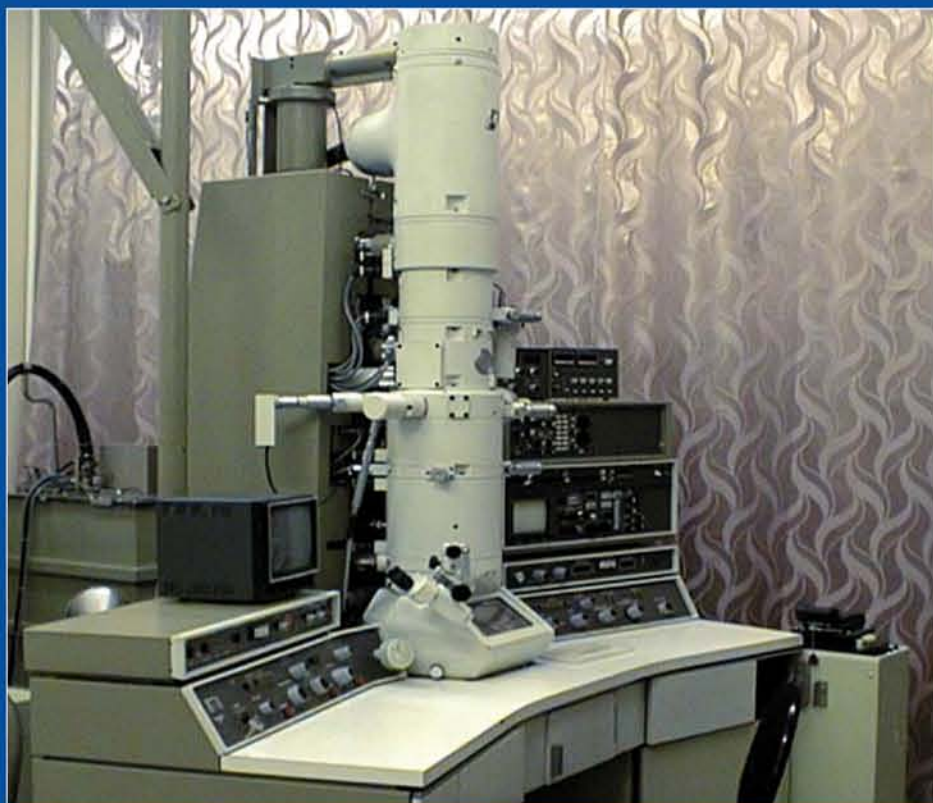
Просвечивающий микроскоп JEM-200CX фирмы JEOL (Япония) с разрешающей способностью 0,2 нм и максимальным рабочим увеличением \times 300000
