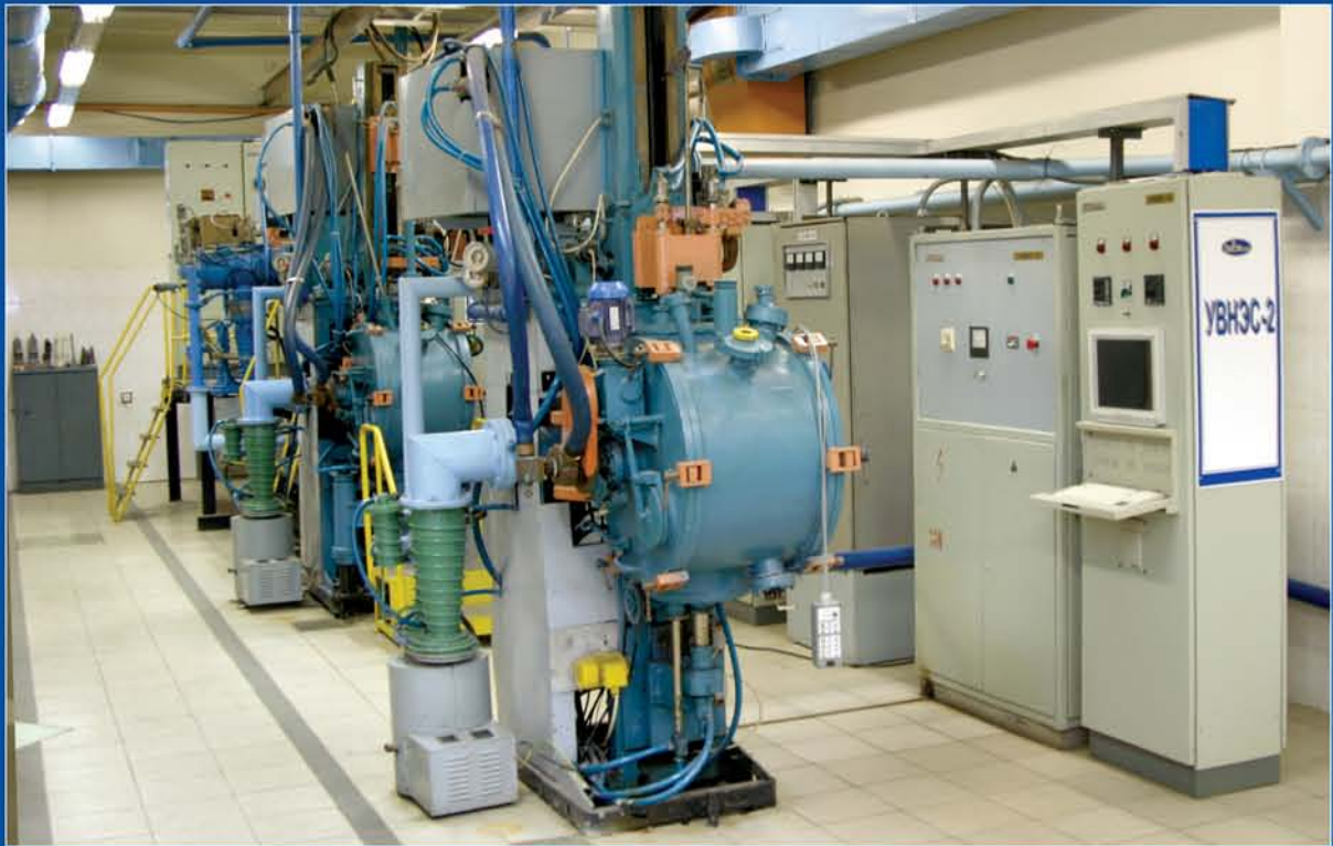
Комплекс установок для литья монокристаллов методом высокотемпературной направленной кристаллизации. Центр им. академика С.Т. Кишкина
