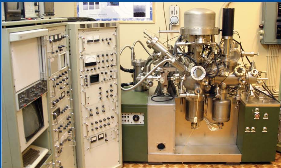
Многоцелевая установка ESCALAB-5 для исследования состояния поверхности металлов методом Оже-, фотоэлектронной и ультрафиолетовой спектроскопии
