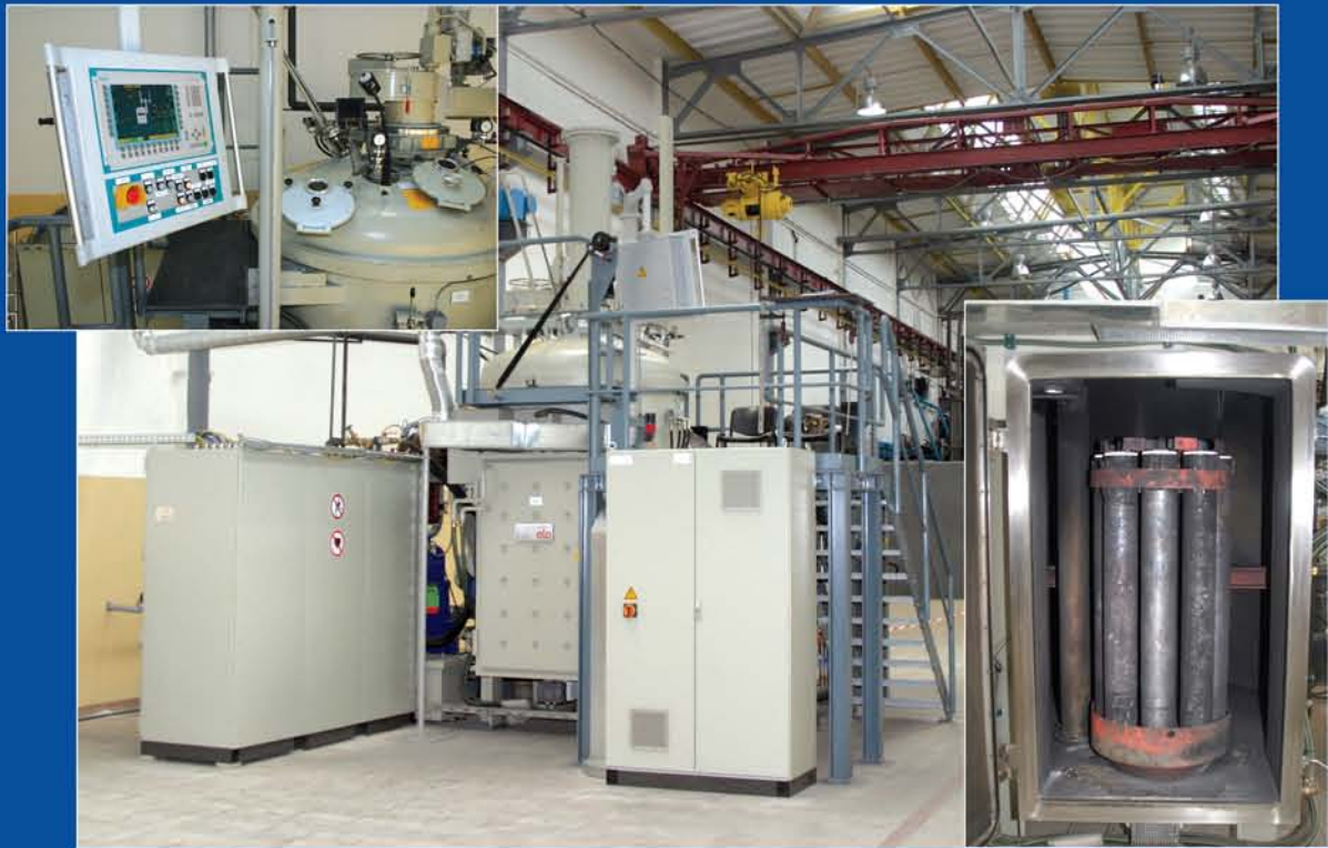
Вакуумная индукционная печь VIM-50 фирмы ALD (Германия) для выплавки жаропрочных сплавов
