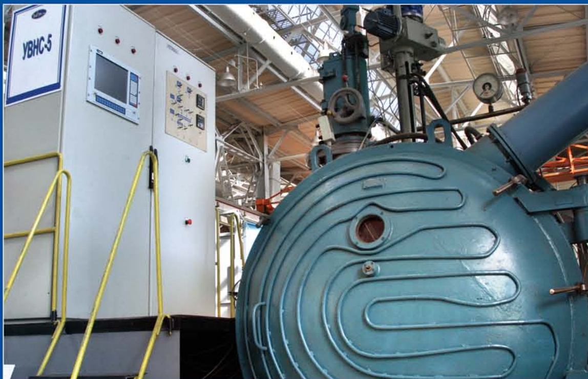
Установка УВНС-5 для высокоградиентной направленной кристаллизации жаропрочных сплавов
