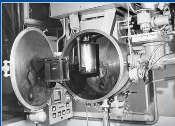
Первые установки для литья монокристаллических лопаток и образцов
