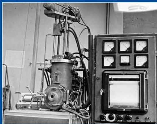
Первые установки для литья монокристаллических лопаток и образцов
